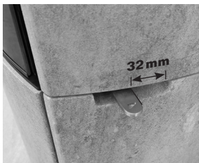
Air secondaire / Pleine combustion Charge nominale 6 kW 32 mm de la butée droite
