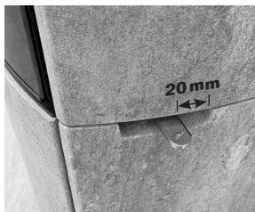
Air secondaire / Pleine combustion Charge partielle 3 kW 20 mm de la butée droite
